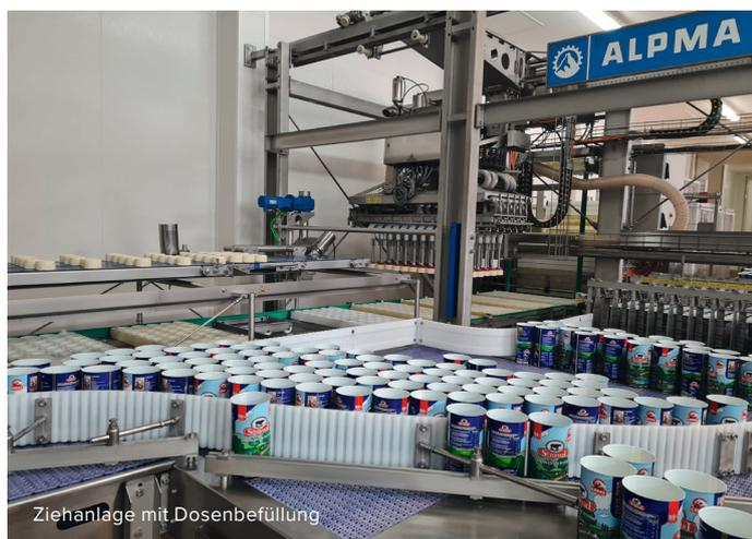
Ziehanlage mit Dosenbefüllung
